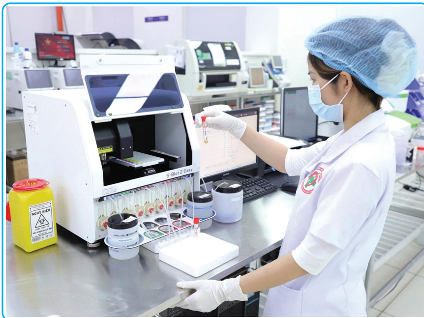
Hệ thống máy tự động S-Blot 2 Easy (Hàn Quốc) có khả năng xét nghiệm cùng lúc 102 tác nhân gây dị ứng.
